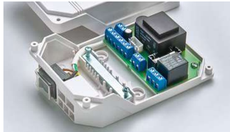
Фото 6. Блок управления со снятой крышкой. Отверстия для ввода в блок питания кабелей и планка (на двух винтах) для их крепления
